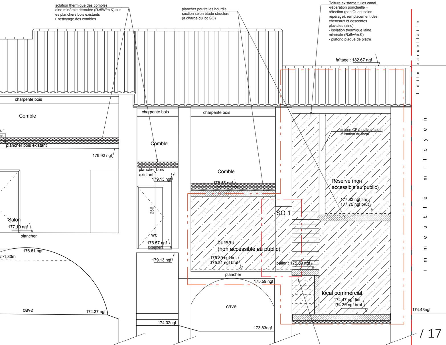
isolation thermique des combles
