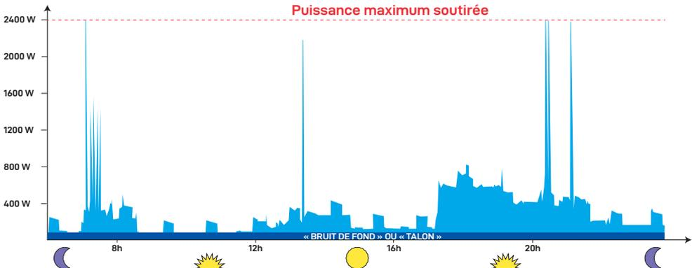
Sur cette courbe de charge, la puissance minimale appelée (aplat bleu foncé) dans le logement est de 60 Watts.
