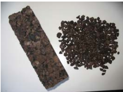
Liège expansé vrac et panneau
