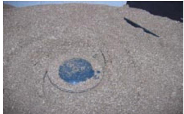
*Râteau dans un silo de stockage de copeaux (plaquettes)*
