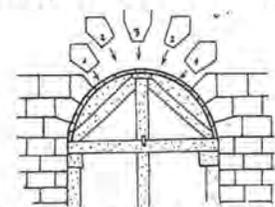
④ L'arc est monté en respectant l'ordre de pose des pierres, la clé étant le dernier claveau mis en place. On peut alors enlever le coffrage.
