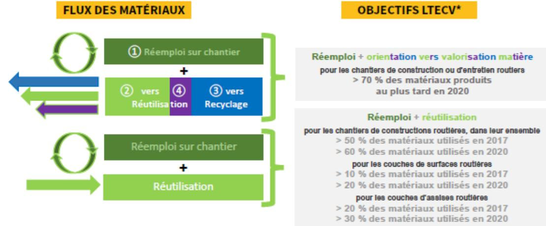
*Le réemploi et le recyclage utilisés en technique routière sont soumis un contrôle environnemental qui. Il est complémentaire de la démarche d'acceptabilité de matériaux alternatifs.*
