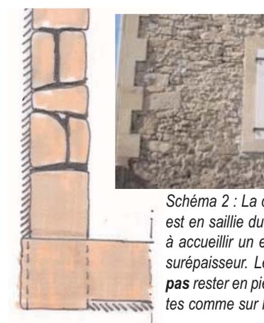
Schéma 2 : La chaîne d'angle est en saillie du mur, destinée à accueillir un enduit dans sa surépaisseur. Le mur **ne doit pas** rester en pierres apparentes comme sur la photo
