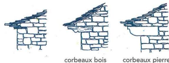
**Egout :** les lauzes les plus grandes, ou **goutiers** (de 0,60 à 1,20m) protègent les murs en bas de pente et forment le **coyau**. Elles reposent sur des voliges à plat maintenues par des **corbeaux** ; en l'absence de corbeaux, ce sont des lauzes scellées en tas de charge qui supportent les goutiers. Cela permet d'éviter chéneaux et descentes d'eaux pluviales.
