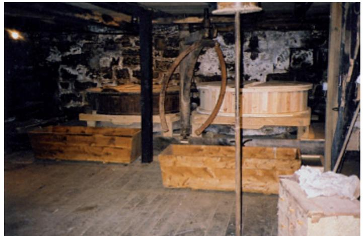
Chambre des meules et mécanismes restaurés d'un moulin à eau (Linac)
