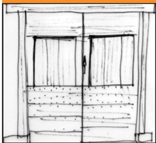
Porte d'étable à double battant avec coeur en planches verticales, encadré de planches horizontales. L'encadrement repose sur deux pierres pour éviter le pourrissement du bois.
