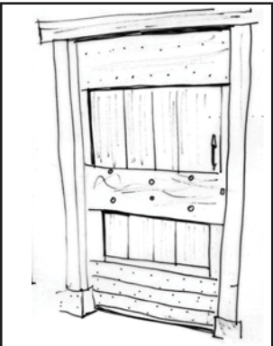
Porte à un seul battant composée de planches verticales et horizontales.
