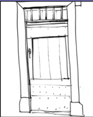
Porte d'entrée avec imposte vitrée. Le coeur est en planches verticales, encadré de planches horizontales. L'encadrement repose sur deux socles en pierres.
