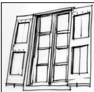
Fenêtre à petits bois et volets traditionnels.
