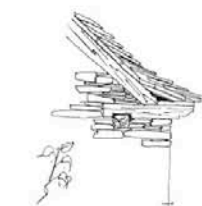
Toiture à "coyau" (Illustration de P. Gironnet)
