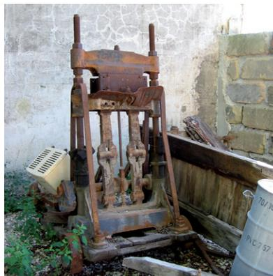
Presse à rebattre pour une fabrication plus mécanisée
