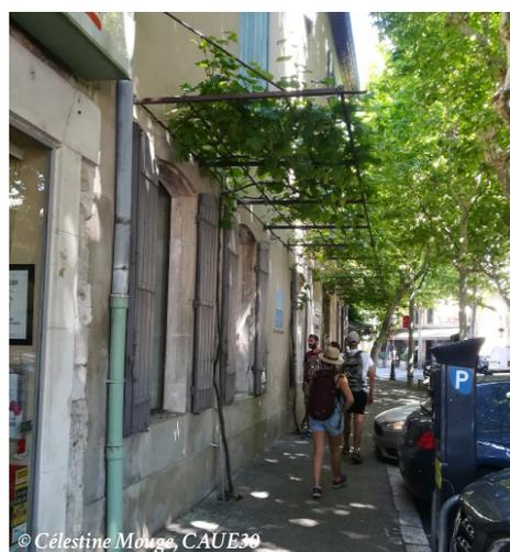
Dans le cas d'une végétalisation de façade, le dispositif doit être discret : câble métallique. Dans le cas d'un auvent il doit lui-aussi être métallique et simple.
