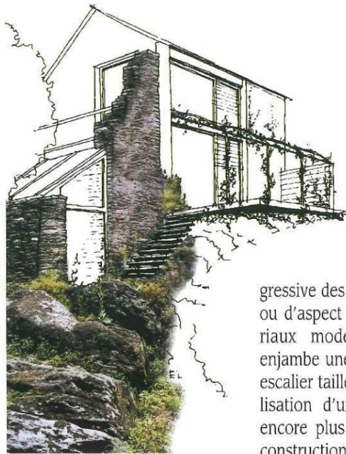
En site isolé, le choix des matériaux s'inspire de la nature. Il se base sur les caractéristiques du site et décline, en une transition progressive des matériaux naturels bruts ou d'aspect grossier avec des matériaux modernes. Une voûte qui enjambe une faille, un dallage ou un escalier taillé à même le rocher, l'utilisation d'un mur ancien, rendent encore plus floue la limite entre la construction et son milieu.
