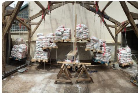
Test en charge d'une charpente traditionnelle réemployée
