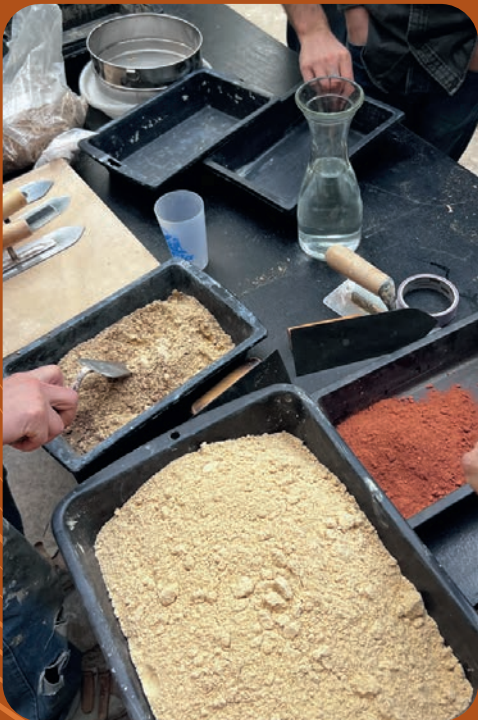
Tests d'enduit à base de terre de différentes provenances © CAUE 34
